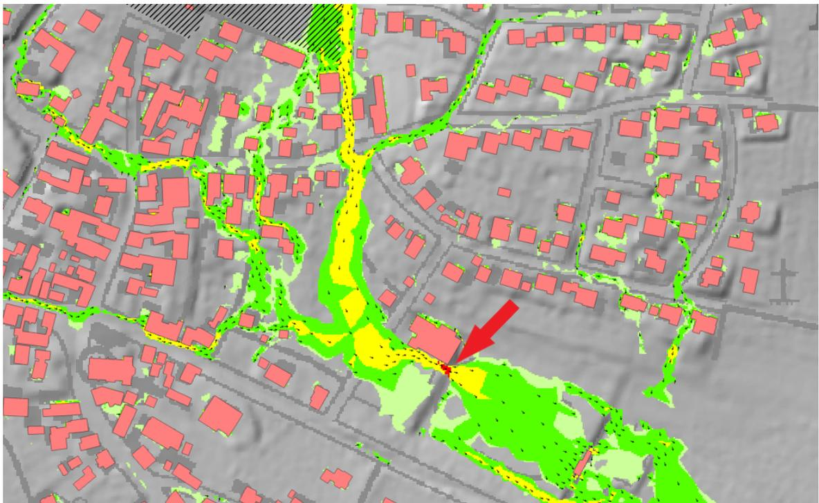
Abbildung 13: Maximale Fließgeschwindigkeiten (> 2 m/s) am Eingang zum Sportplatz in Stadtteil Obergriesheim
